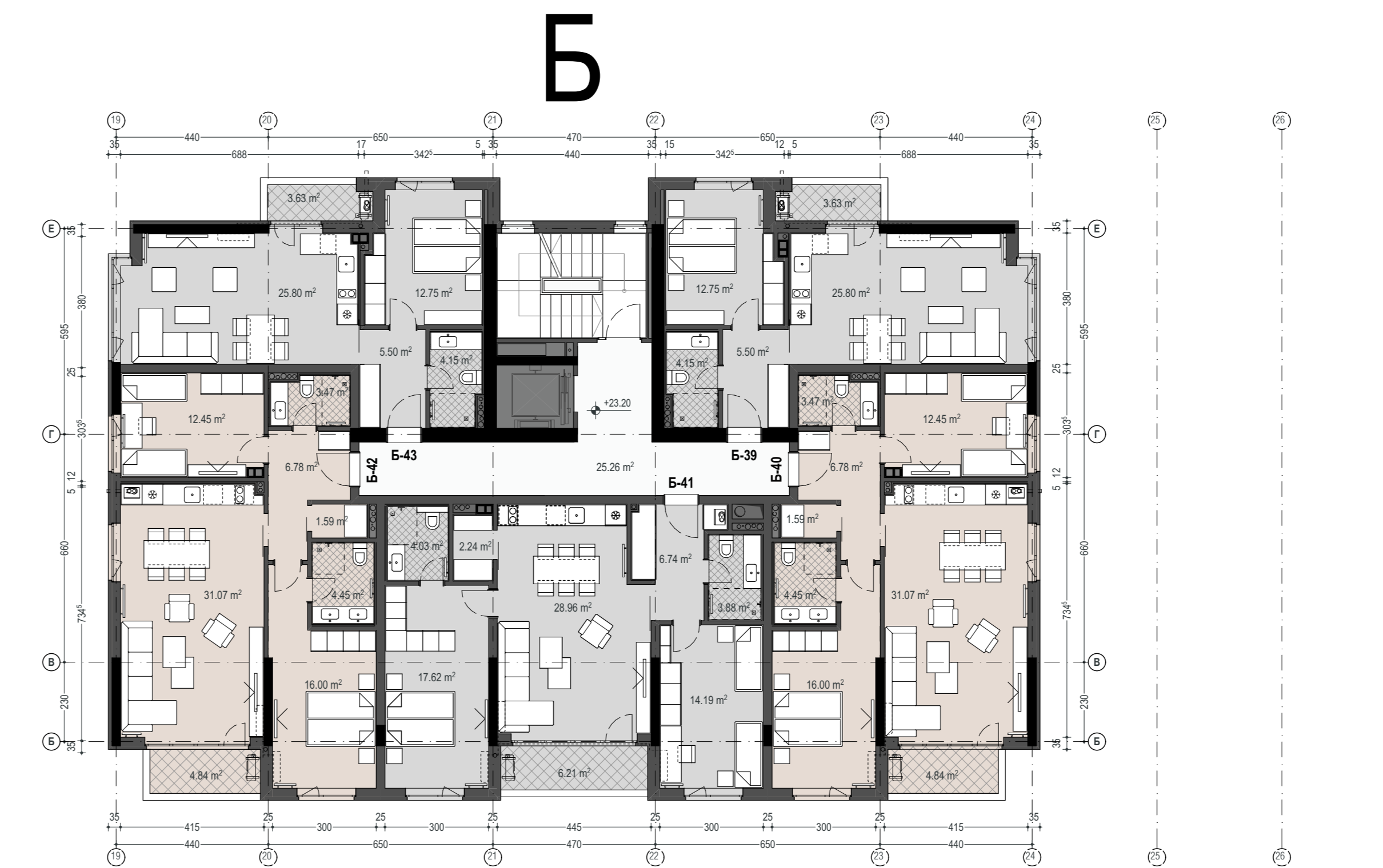
СЕКЦИЯ Б РАЗРЕДЕНИЕ - ОСИМ ЭТАЖ (М 1:125) ЖИЛИЩА ЗП - нето ЗП - бруто АП Б-41 97.02 кв.м 114.51 кв.м АП Б-39 62.33 кв.м 73.56 кв.м АП Б-42 94.11 кв.м 111.07 кв.м АП Б-40 94.11 кв.м 111.07 кв.м АП Б-43 62.33 кв.м 73.56 кв.м
